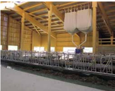
DeLaval Selbstfangressgitter Toronto 09 und Krafffutterstation FSC400. Beides ideale Komponenten im modernen Milchviehstall
