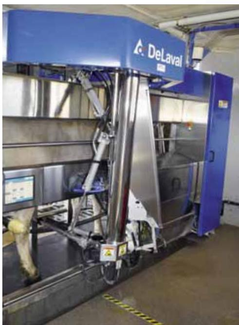
Bei Villigers melkt ein DeLaval VMS Melkroboter: Eine komplett aus Edelstahl gehaltene Box steht für Langlebigkeit und Beständigkeit. Der Informationsbildschirm mit Touch Screen ist direkt beim Euter positioniert. Hier können sämtliche Überwachungsdaten pro Kuh abgerufen werden.
