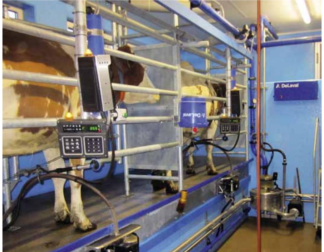
Tandem Melkstand 2 x 2 mit Melkplatz-Controller MPC680, CombiCover Melkzeugaufnahme und ICAR anerkanntem Milchmengenmessgerät MM15.
