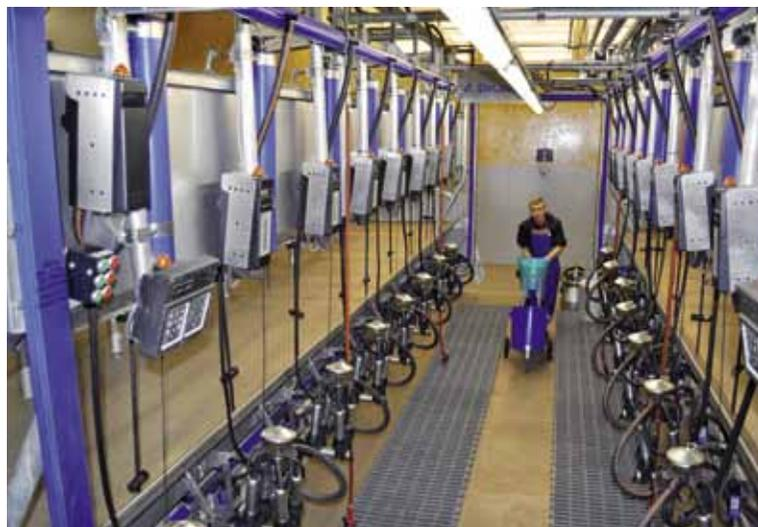
Der Parallel Melkstand P2100 ermöglicht das Melken der Kühe von hinten. Der Melkstand ist mit den Melkplatz-Controllern MPC580/680 ausgerüstet. Die Milchmengenmessung erfolgt über den Milchmengen- messer MM27 mit integrierter Blut- und Leitfähigkeitskontrolle.
